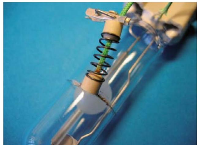
Abbildung 35: Spannen des Thermoelementes auf dem Außenkolben mittels eines Federelementes
