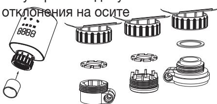
Вентилите от различни производители може да имат колебания на толеранса, които правят радиаторния термостат на вентила. В този случаи представените отворен пръстен трябва да се постави във фланецата преди монтирането на радиаторния термостат. В никаки случаи, когато щифтът на вентила има
