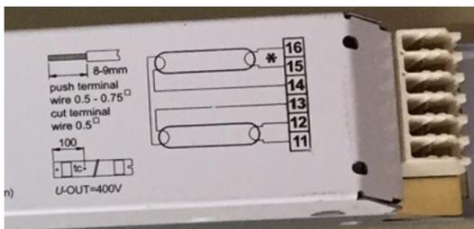
Schritt 2: zweite Leitung der Sicherung mit Leitung „11“ und „16“ verbinden
