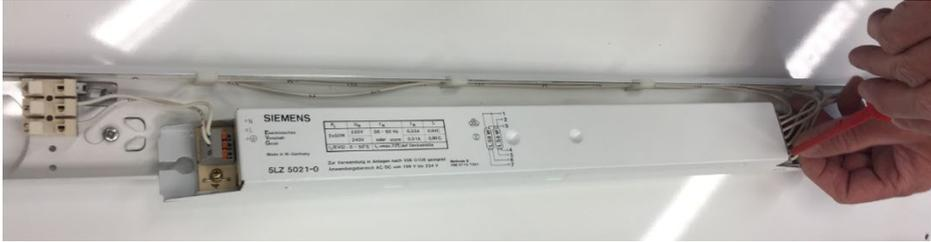
Schritt 1: Netzleitung „L“ mit einer Leitung der Sicherung verbinden
