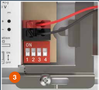
DIP switch voor het instellen van de vermogensstappen
