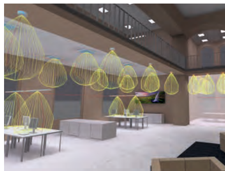
Vista 3D del posizionamento bilanciato di sensori e sorgenti luminose per ottenere la distribuzione della luce desiderata.
