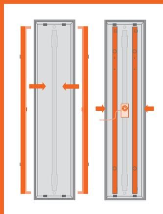
LINEAR MAGNETIC BATTEN T5 mit Hilfe der Magnetbefestigung einsetzen und mit der werkzeuglosen CONNECTOR BOX an die Stromversorgung anschließen
