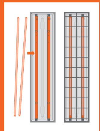
Neue LED TUBE T5 AC und Raster einsetzen. Fertig!
