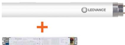
Rüsten Sie die vorhandene Leuchte auf LED-Technik um, indem Sie das LED Tube External System installieren. Der LED DRIVER LED TUBE EXTERNAL P ist ein Multi-Watt-Treiber, welcher für alle Arten von LED TUBE T5/T8 EXTERNAL P geeignet ist. Da er über die gleichen Abmessungen wie herkömmliche FL-EVGs verfügt, können die vorhandenen Leitungen in der Leuchte zum Anschluss dieser verwendet werden.
