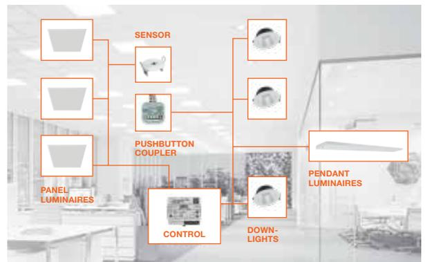
**VIVARES DALI pour bâtiments neufs :** les Panels, les Downlights et les détecteurs sont intégrés dans les plafonds suspendus et connectés ensemble via 2 lignes, appelées "bus" DALI. De plus, des luminaires suspendus, connectés à ce même bus DALI, ont été installés dans la salle de conférence.
